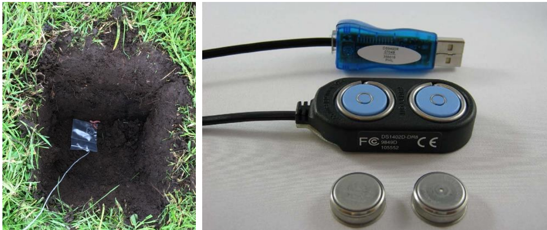
Figuur 3. a) Installatie van i-buttons (DS1921G Thermochron® iButton®, Maxim Integrated) geseald in een plastic zakje voor het meten van bodemtemperatuur op 10 en 20 cm diepte in de 8 monitorveldjes. b) close-up van de i-buttons en het uitleesapparaat (TDHC 400 thermochron reader, Maxim Integrated).
