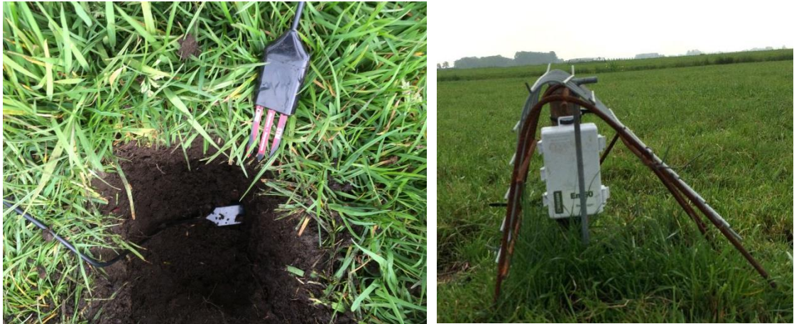
Figuur 2. Installatie van bodemtemperatuur- en vochtsensoren (Decagon, type 5TM) en loggers (Decagon, type Em50) op 10 en 20 cm diepte en loggers in vier monitorveldjes (één per systeem). Een metalen constructie beschermt de logger tegen vertrapping en ander vandalisme door de grazende koeien.
